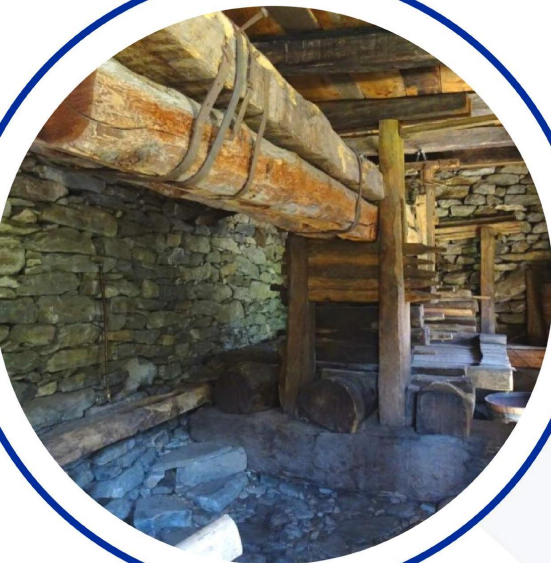
LA MACCHINA SI PRESENTA IN OTTIMO STATO DI CONSERVAZIONE, È DI TIPO AUTOPORTANTE A VASCA SOSPESA E SERVIVA ESCLUSIVAMENTE PER LA SPREMITURA DELLE VINACCE PER LA PRODUZIONE DEL VINO.
